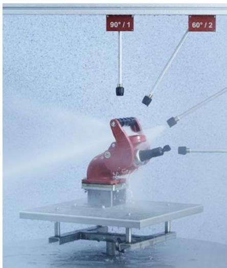
针对喷水防护的 IP 测试系统
