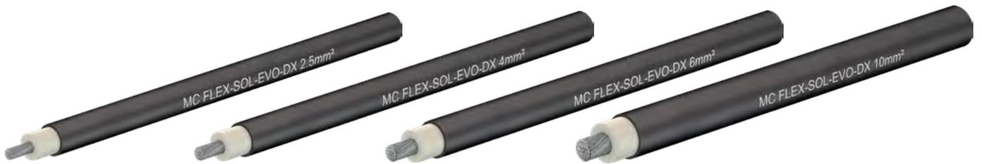
低烟、无卤、柔性、单芯且交联双层绝缘电缆，特别适用于光伏直流侧连接使用。电缆适用于导体之间和导体与地面之间直流电压标称为1.5 kV (IEC) 的绝大多数等级II光伏设备。允许的最大工作直流电压为1.8 kV。
